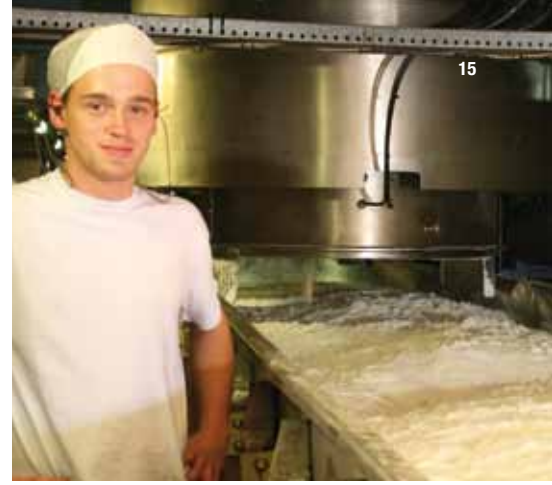
Aus der Zentrifuge fällt der Weißzucker auf dieses Förderband, von wo er zur Lufttrocknung kommt.
