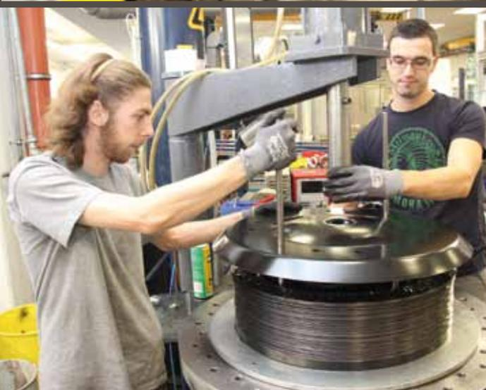
Diese beiden jungen Arbeiter in der Montage bringen gerade einen Ventilschutz an, der die Wucht einer etwaigen Explosion abfangen soll.
