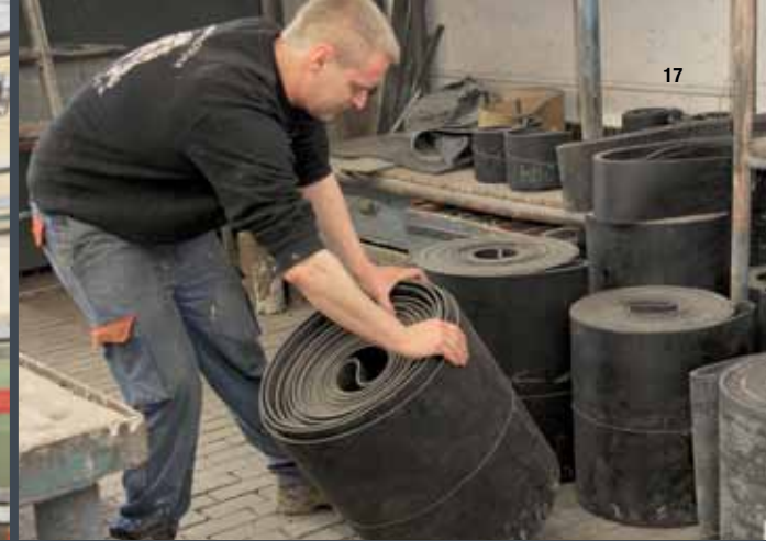
In einer eigenen Werkstatt für „Gummi“ werden vor allem die Förderbänder gewartet. Förderbänder sind in der chemischen Produktion essentiell.
