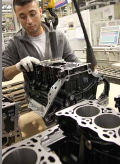
Die offenen Motorblöcke mit ca. 25 Kilogramm Gewicht werden mit speziellen Hubvorrichtungen vom Förderband genommen.
