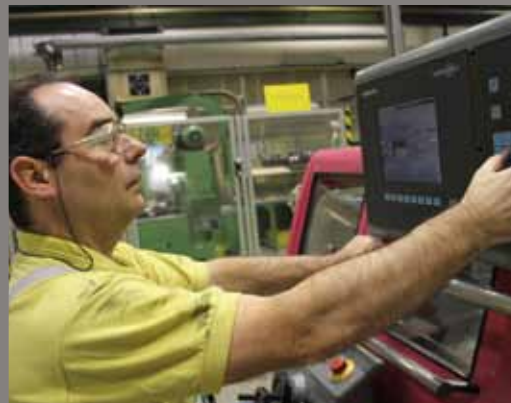
Eine eigene Werkstatt sorgt für die richtigen Werkzeuge für die Produktion. Hier programmiert Stephan Sadil eine CNC-gesteuerte Drehmaschine.
