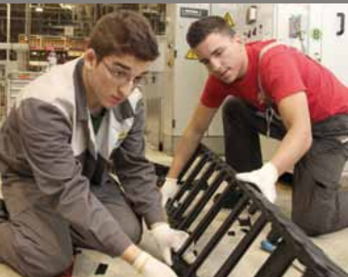
Lehrlinge im zweiten und dritten Lehrjahr helfen auch bei der Instandhaltung, in diesem Falle bei der Reparatur eines Förderbandes.
