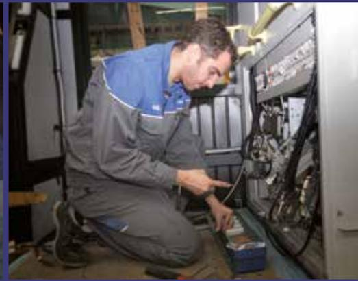
Elektrik-Montagearbeiten und Messarbeiten innerhalb eines U-Bahn-Waggon vor der Fertigung.
