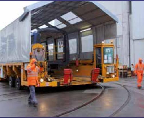
Die riesigen „Umsetzer“ bewegen die halbfertigen und tonnenschweren Waggon innerhalb des Werkes zu den verschiedenen Montagebereichen.
