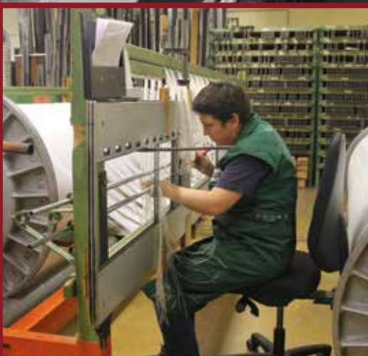
Die 38 Webmaschinen sind auf dem neuesten Stand der Technik und arbeiten größtenteils vollautomatisiert. Nur zwei WeberInnen und zwei Vorrichter sind hier noch beschäftigt. Sie müssen z. B. anknüpfen, wenn die Spulen gewechselt werden.
