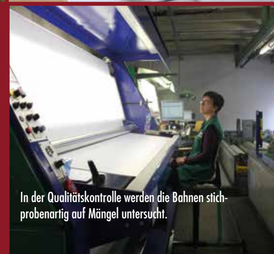
Die 38 Webmaschinen sind auf dem neuesten Stand der Technik und arbeiten größtenteils vollautomatisiert. Nur zwei WeberInnen und zwei Vorrichter sind hier noch beschäftigt. Sie müssen z. B. anknüpfen, wenn die Spulen gewechselt werden.
