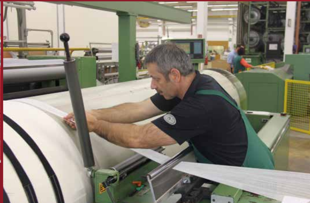
Damit das Richtige der rund 360 Muster gewebt wird, müssen die Garne in der Schärerei zuerst in der richtigen Reihenfolge aufgesteckt werden.
