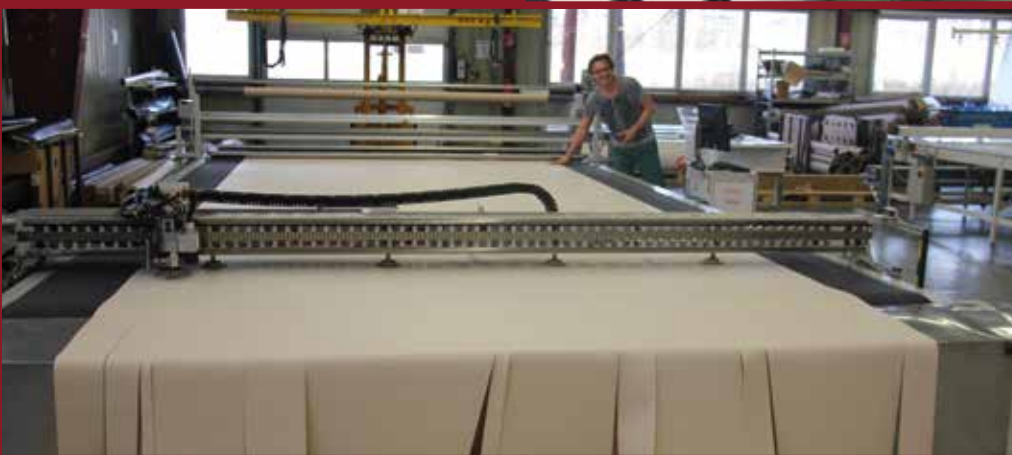
Hier werden gerade Volants für die Markisen – das Hauptgeschäft der Firma – hergestellt. Von Jänner bis September herrscht hier Hochbetrieb.
