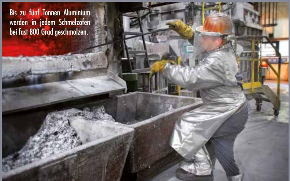
Bis zu fünf Tonnen Aluminium werden in jedem Schmelzofen bei fast 800 Grad geschmolzen.
