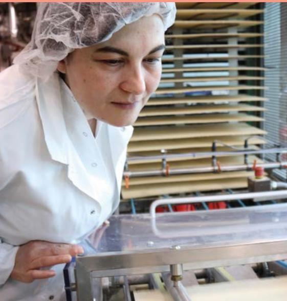
Mit dem Schließen des Werks in Perg wurde 2016 der weltgrößte Waffelofen zerlegt und im vierten Stock des neuen Gebäudes wiederaufgebaut. Auch kleinere Waffelöfen stehen hier. Die Abwärme aus dem Backprozess wird teilweise umgewandelt und zum Kühlen verwendet, der Rest wird in das Fernwärmenetz gespeist.
