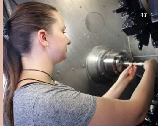
An dieser Maschine werden Teile für die Hydraulik gedreht und gefräst. „Das ist Präzisionsarbeit im My-Bereich. Die Sicherheit von Menschen hängt davon ab, dass hier ganz genau gearbeitet wird“, erklärt Cypra.
