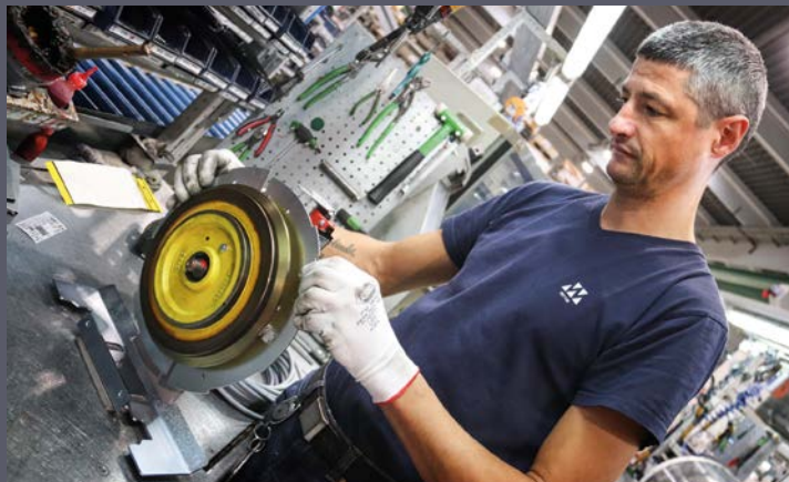
Die Geschwindigkeitsregler sorgen auch im Notfall für die Sicherheit des Fahrkorbs.
