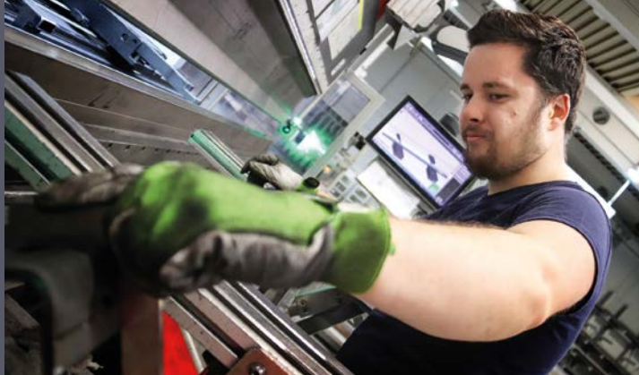
Konzentration und Genauigkeit sind bei der Biegemaschine gefragt. Hier wird der korrekte Winkel gemessen.
