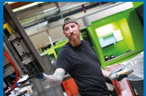
Dieses Spritzgusswerkzeug ist noch eines der „Kleinen“ und hat ungefähr 400 Kilogramm.
