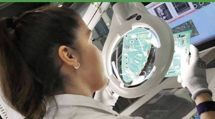
Für die optische Kontrolle der soeben bestückten Platinen braucht es geschulte Augen.
