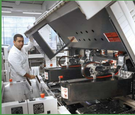
Die großen Maschinen sorgen vollautomatisch für die Fertigung der Platinen.
