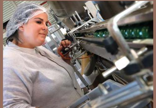
Die Abfüllanlage bläst die Gläser zuerst aus, bevor sie befüllt werden. Die Maschine schafft 8.500 Gläser pro Stunde, das sind in etwa zwei Paletten.
