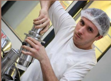
Sauberkeit hat in jedem Lebensmittelbetrieb oberste Priorität. Dieser Arbeiter baut nach einem Reinigungsprozess die Dosiermechanik einer Abfüllvorrichtung wieder zusammen.
