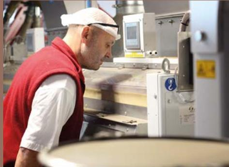
Nach der Qualitätskontrolle werden die Gewürze mehrmals gereinigt, metalldetektiert und gesiebt. In dieser Siebmaschine bleiben alle Fremdkörper wie Steine oder Glas zurück
