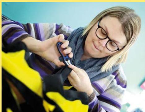
Im abschließenden Arbeitsschritt werden die überstehenden Fäden abgezwickt, das verlangt genaues Arbeiten.
