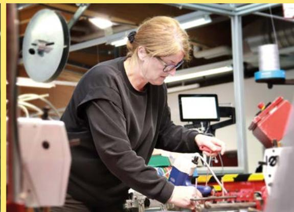
Der Nähautomat konfektioniert rechts und links gleichzeitig und ist für höhere Stückzahlen gedacht. Die Bedienung braucht Erfahrung.
