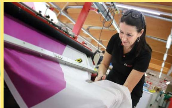
Am Schneideautomat (Slitter) werden die Fahnen seitlich beschnitten, sodass die Mitarbeiterin nur mehr quer schneiden muss.
