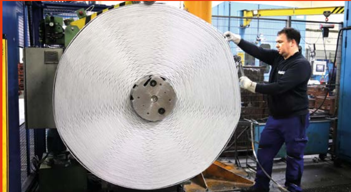
Um beim gegossenen Band die gewünschte Stärke zu erreichen, wird es zuerst warm- und danach kaltgeformt und aufgewickelt.
