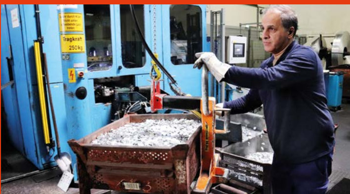
Butzen sind Scheiben oder Ringe aus Aluminium in unterschiedlicher Dicke, die zu Verpackungsmaterial weiterverarbeitet werden.
