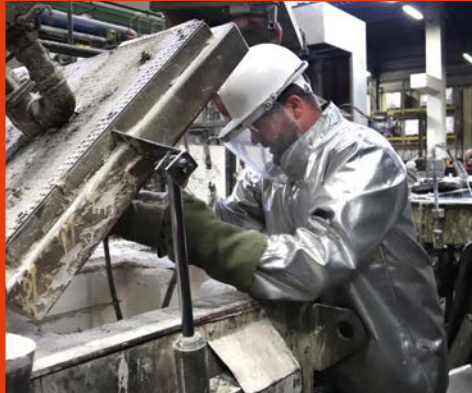
Aus dem Aluminium werden lange Bänder und Stangen horizontal gegossen.
