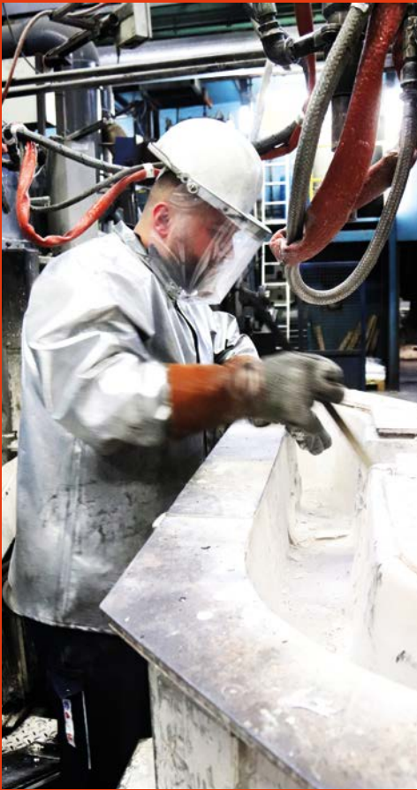
Hier werden gerade die noch heißen Keramikfilter gereinigt, durch die das Aluminium fließt.
