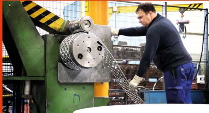
Aus dem fertigen Band werden sogenannte Butzen gestanzt. Die Reste werden neu eingeschmolzen.
