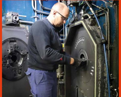
Die Stangen können einen Durchmesser von 45 bis 203 mm haben. Dieser Arbeiter rüstet gerade um.
