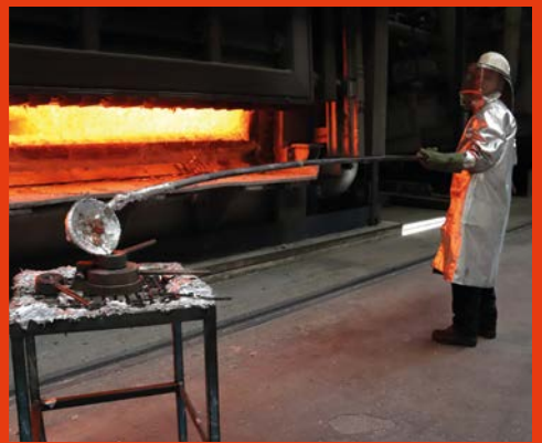
Hitzeempfindlich darf man am Hochofen nicht sein. Bei 750 Grad wird das Aluminium geschmolzen.
