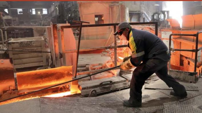
Reinigung des Abstichs beim Flammofen. Im anschließenden Gießkarussell werden die Anoden gegossen.
