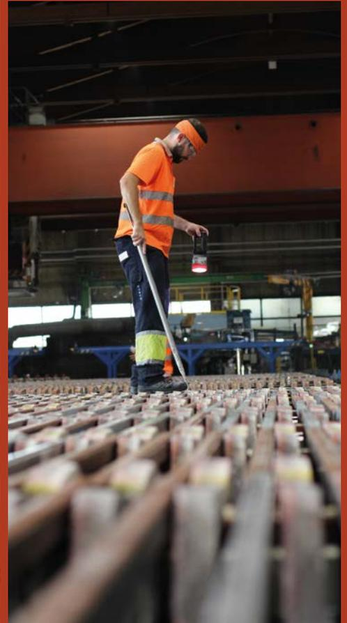
Kontrolle der Kontakte in der Elektrolyse. Hier wird das Kupfer auf bis zu 99,99 Prozent veredelt.
