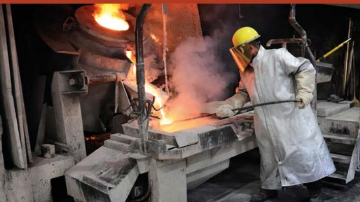
Vor der Produktion muss bei der Bemusterung das Rohmaterial in kleine Proben gegossen werden.
