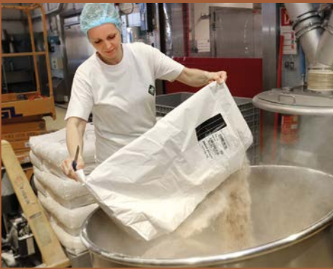
Alles beginnt in der „Mischerei“. Hier werden die Zutaten abgewogen und in der Knetmaschine vermengt.
