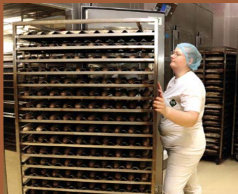
Die fertigen Gebäckstücke werden vorgebacken und kommen danach – je nach Größe – für 45 bis 120 Minuten in den -30 °C kalten Schockfroster.
