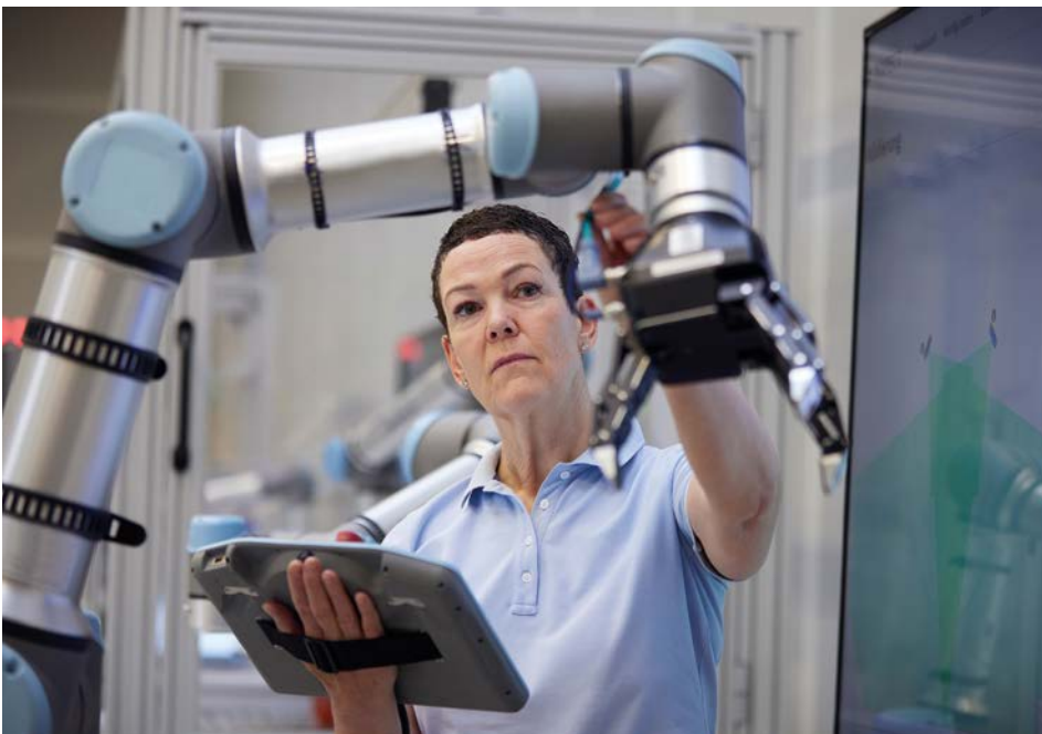
Der kollaborative Roboter (Cobot) kommt im Gegensatz zum klassischen Industrieroboter ohne Schutzzaun aus. Cobots arbeiten mit Menschen im selben Arbeitsbereich zusammen. Ausgefeilte Sensortechnik soll dafür sorgen, dass für den Menschen keine Verletzungsgefahr besteht.
