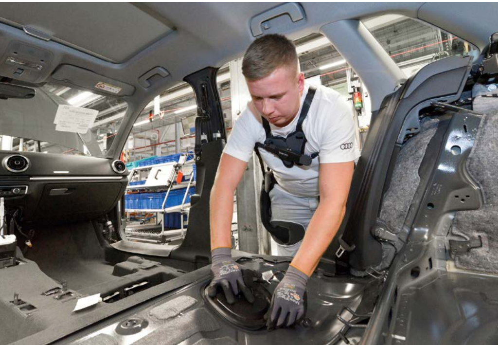
Exoskelette unterstützen beim Ausführen körperlich anstrengender Tätigkeiten, wie hier beim Einsetzen der Innenraumverkleidung bei Audi in Deutschland.
