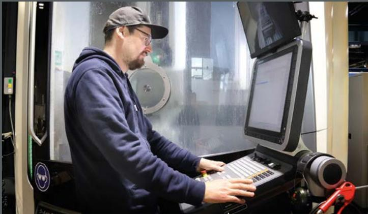
Die Spritzgusswerkzeuge für die Kunststoffteile werden im Werkzeugbau, wie hier an der 5-Achs-Fräsmaschine, hergestellt.
