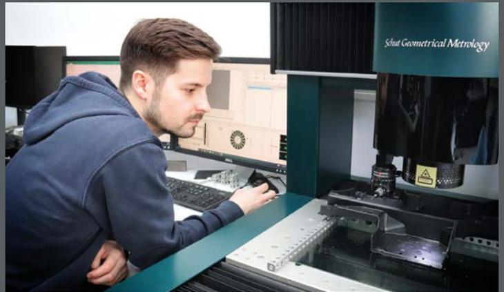
In der zertifizierten Qualitätssicherung wird überprüft, ob die Kunststoffkomponenten allen Anforderungen und Normen entsprechen.
