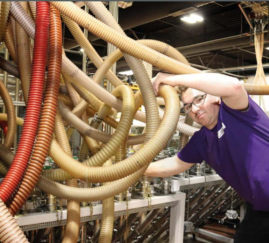
Schläuche und Rohrleitungen versorgen die Spritzgussmaschinen über die zentrale Vortrocknungsanlage mit Kunststoffgranulaten.
