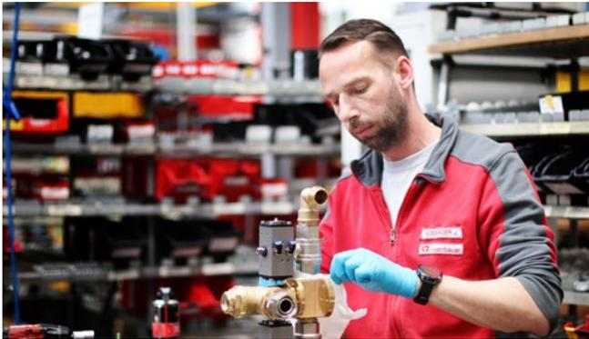
Eine Feuerlöschpumpe ist ein technisch hoch komplexes System, das aus mehreren mechanischen und hydraulischen Komponenten besteht. Alle Teile werden in der Halle gefertigt, bevor sie zusammengebaut werden.
